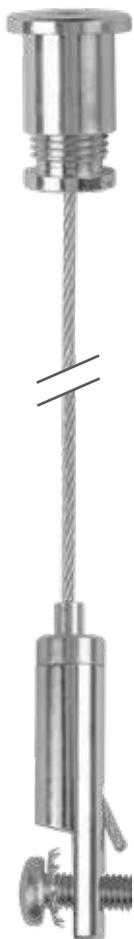
Kit de suspension avec câble en acier de 1,5 mm et fixation rapide au plafond, avec à l'extrémité un crochet pour la suspension de publicités, itinéraires et autres panneaux/objets jusqu'à une épaisseur maximale de 10 mm. Ce kit est réglable en hauteur et convient pour la suspension d'objets pourvus de trous de suspension.
