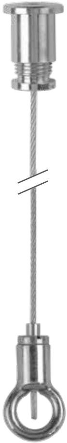
Kit de suspension avec câble en acier de 1,5 mm et fixation rapide au plafond avec à l'extrémité un œillet fermé pour la suspension de luminaires, panneaux, publicités et autres objets. Ce kit est réglable en hauteur et peut également être utilisé en position horizontale.
