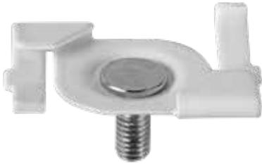
Un clip laqué blanc pour faux plafond avec filetage M5. Le clip peut être vissé en un tournemain dans un support du faux plafond. Il est possible de visser les kits de suspension non réglables avec fixation au plafond sur le filetage M5. Cela garantit une finition propre sans besoin de percer.
